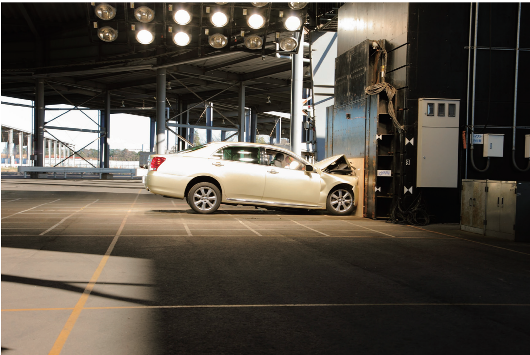
写真 2：AACN 搭載車両が時速 50km でバリアに衝突したところ
